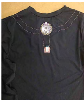
Figura 6 – Microprocessador e bluetooth aplicados na blusa.
