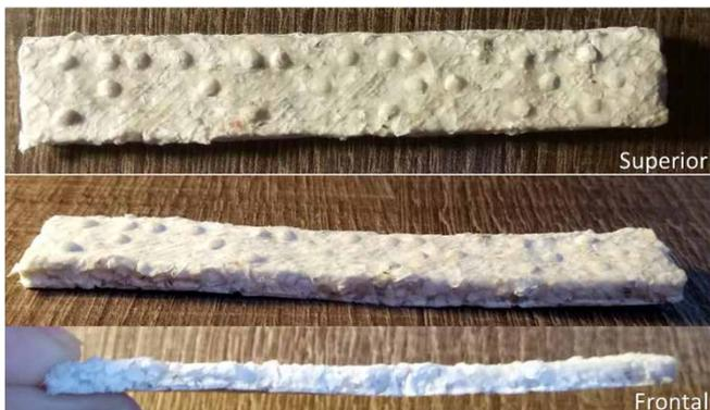
Figura 8. Placa tátil com elementos em Braille.
