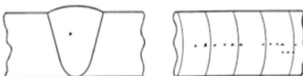
Figura 20 – Exemplo de descontinuidade na soldagem
