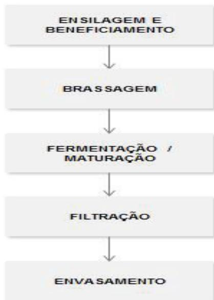
Figura 1 - Visão geral do processo produtivo da empresa
