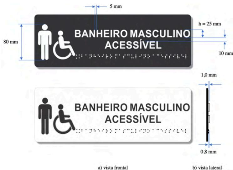
Figura 1: Proposta de placa de sinalização tátil. a) vista frontal b) vista lateral.
