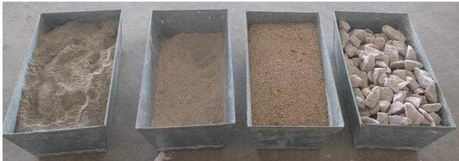
Figura 02 – Materiais utilizados, cimento, cinza, areia e brita, da esquerda para direita.
