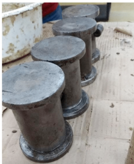
Figura 4 – Confinamento do concreto nos moldes para processo de cura.
