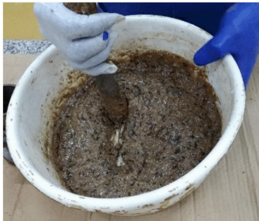
Figura 2 – Mistura do concreto polímero.
