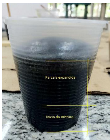
Figura 5 – Demonstração da expansão da resina.
