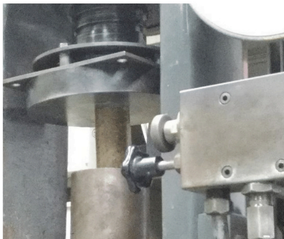
Figura 6 – Demonstração do ensaio de compressão simples.
