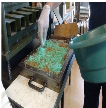
Figura 3.4 – Incorporação das fibras de coco à mistura do agregado reciclado e da resina poliuretana vegetal de mamona.
