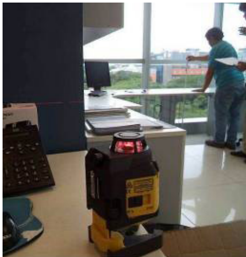
Figuras 8 y 9 – Medición de deformaciones con nivel de láser y con deflectómetros.
