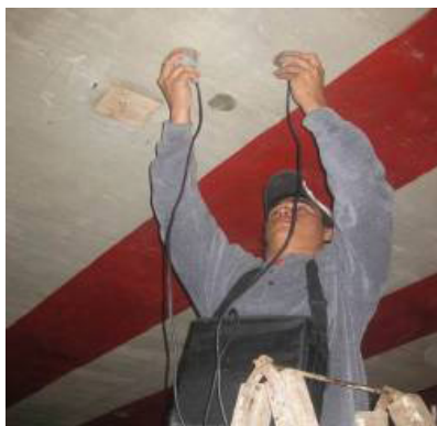
Figuras 6 y 7 – Ensayo de esclerometría y ultrasonido.
