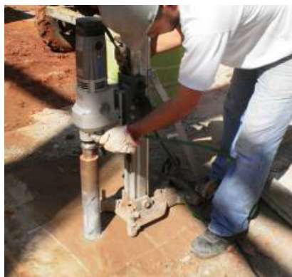
Figuras 4 y 5 – Extracción de probetas testigo de losa postensionada.
