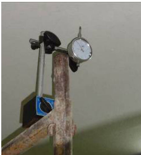
Figuras 8 y 9 – Medición de deformaciones con nivel de láser y con deflectómetros.
