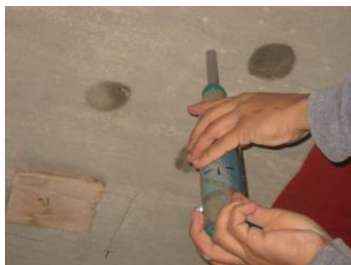
Figuras 6 y 7 – Ensayo de esclerometría y ultrasonido.
