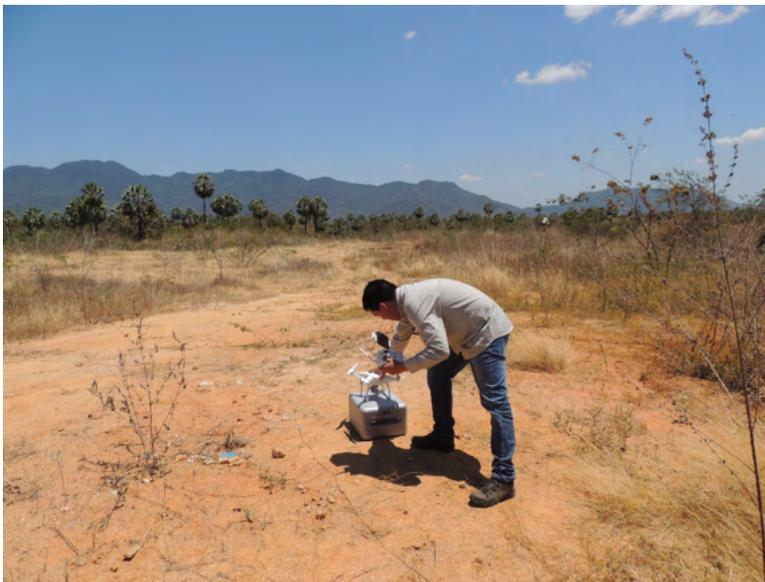
**Figura 2** - Utilização de drones no georreferenciamento de imóveis rurais, relatórios e mapeamentos de cunho ambiental.
