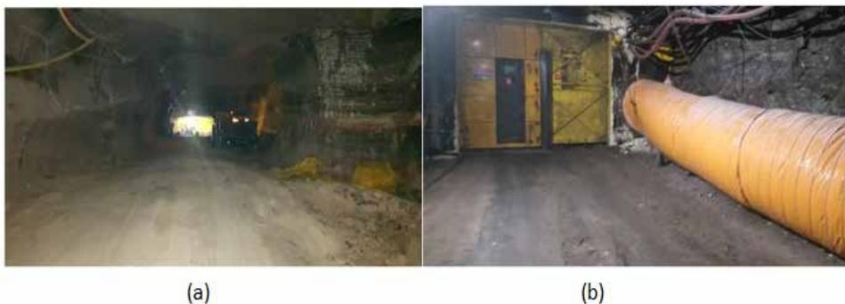
Figura 7- (a) local sem direcionador de fluxo de ar, (b) instalação de porta e reguladores.
