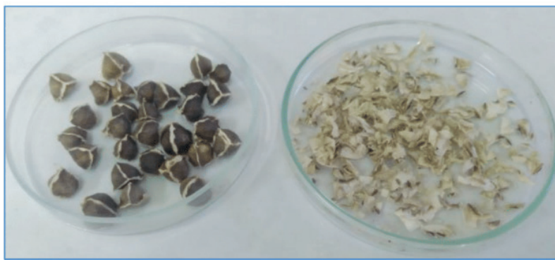
Figura 2: Comparação entre a semente de Moringa oleifera (A: placa à esquerda) e sua membrana “alada” (B: placa à direita), onde o volume de membranas da imagem corresponde diretamente às sementes descascadas em uma relação de 2,5g de sementes para 0,17 g de membranas aladas.
