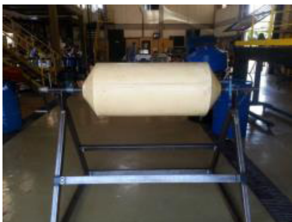
Figura 6. Defesa sem revestimento.
