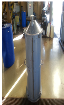
Figura 4. Molde 3, defesa muro-guia e almas de corrente ou tubular.
