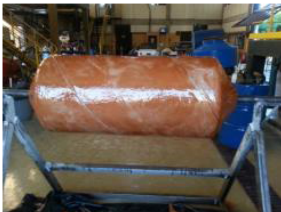
Figura 7. Defesa com revestimento em poliamida.
