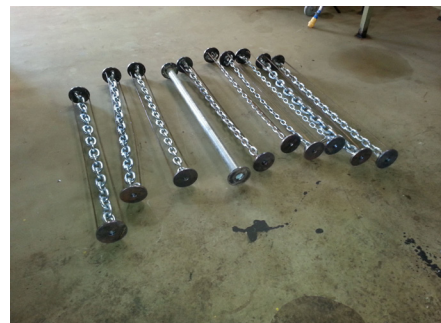
Figura 4. Molde 3, defesa muro-guia e almas de corrente ou tubular.
