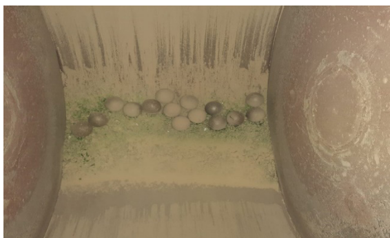
Figura 1 - Trituração das garrafas de vidro por meio do maquinário abrasão Los Angeles.
