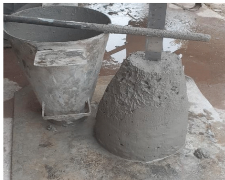
Figura 5 – Ensaio de abatimento do tronco de cone.
