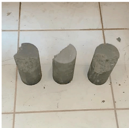
Figura 10 - Concreto modificado submetido ao ensaio de resistência a compressão.
