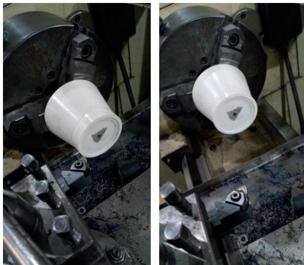
Figura 5. Radiômetro em fase de usinagem no torno mecânico.
