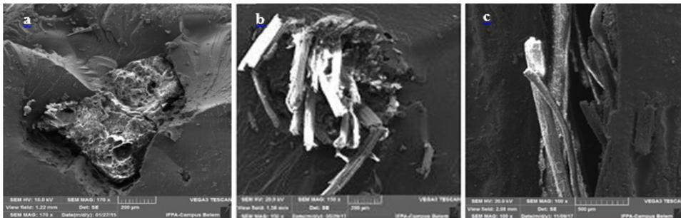
Figura 4 - MEV dos compósitos de resina de poliéster com fibras (a) timbó-çu; (b) juta e (c) tururi.
