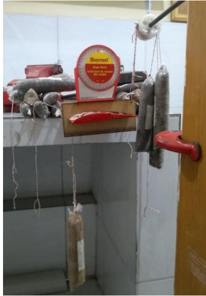
Figura 4 - Ensaio de torção na empenagem horizontal.
