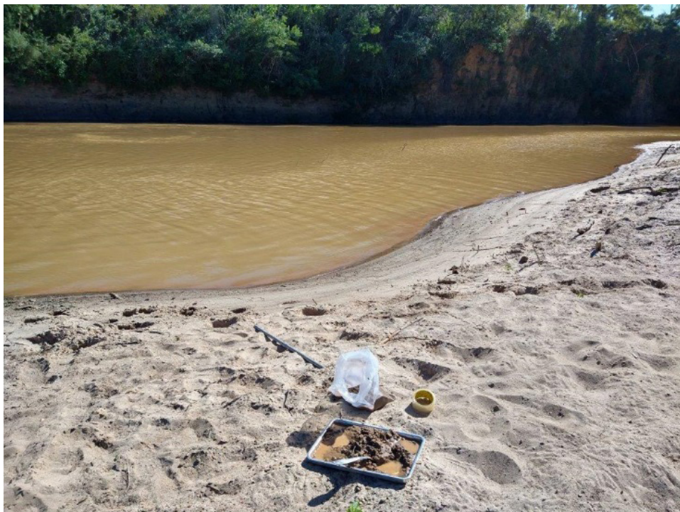
Figura 27: Ponto 48-EX onde ocorre evidências da exsudação de gás natural. Na ocasião foi coletado amostras de água e sedimento para análise geoquímica.
