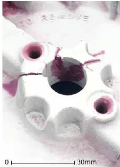
Figura 13. Revelação das Trincas por LP.
