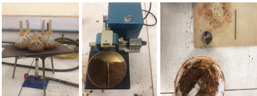
Figura 1: a) Densidade real dos grãos, b) Limite de liquidez, c) Limite de plasticidade.
