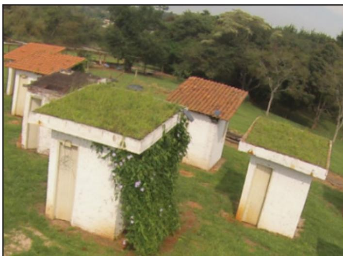
Figura 2: Células de teste detalhe coberturas.
