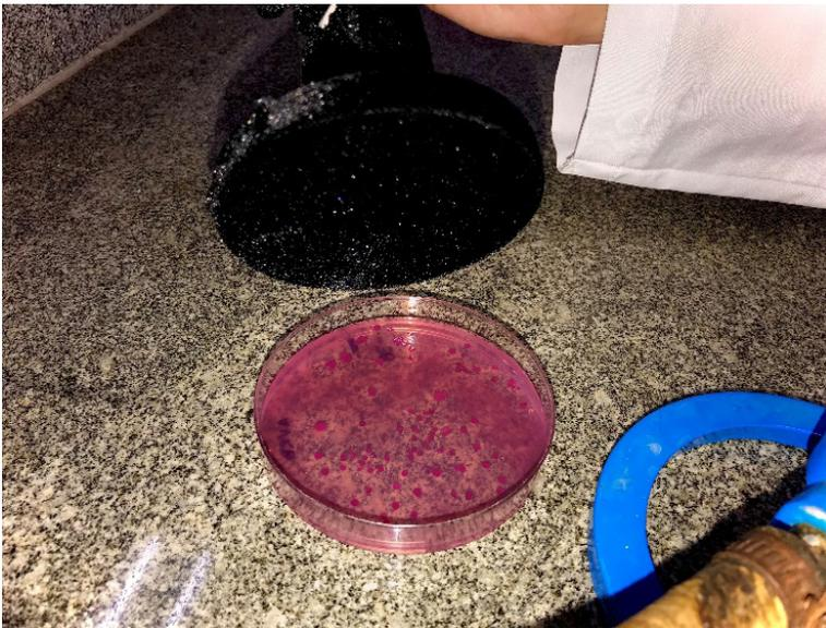
Figura 4. Semeadura e *replica plating*: Carimbo e a placa mestre (AVRB) com crescimento microbiano
