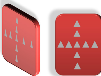
Figura 1: Posicionamento das indentações na amostra em vista frontal (a direita) e em rotação no próprio eixo (a esquerda).
