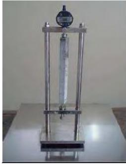
Figura 5 - Equipamento de leitura de expansões.
