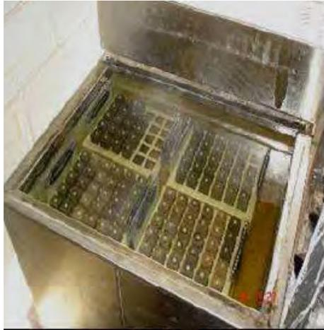
Figura 3 - Banho térmico NaOH 1N controlado à 800C.
