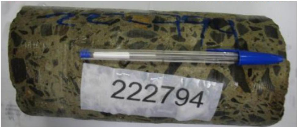
Figura 3 - Distribuição normal dos agregados em meio a argamassa evidencia uma boa homogeneização da mistura.
