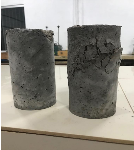
Figura 10 - Ruptura do tipo B aos 07 dias 1,5% de fibra.
