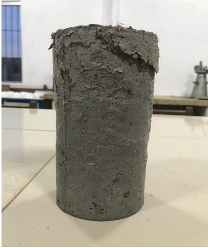
Figura 8 - Ruptura do tipo F aos 07 dias 10% de fibra.
