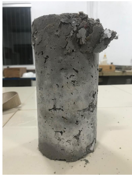
Figura 13 - Ruptura do tipo F, aos 14 dias 1% de fibra.
