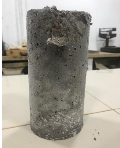
Figura 11 - Ruptura do tipo F aos 14 dias 1,5% de fibra.
