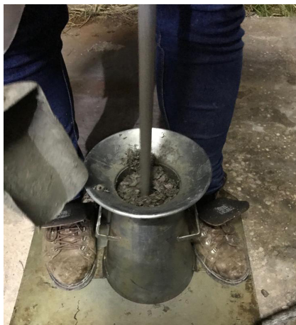
Figura 3 - Ensaio abatimento tronco de cone.
