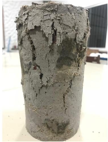
Figura 9 - Ruptura do tipo B aos 14 dias 10% de fibra.
