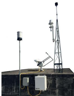
Figura 3.5 – Estação meteorológica.
