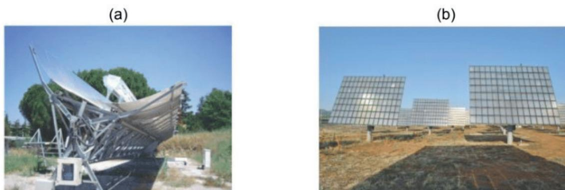
Figura 2.3 – Rastreamento em (a) um eixo e (b) dois eixos.
