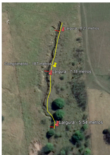
Figura1: Definição de medidas da voçoroca, situada no sítio São Cristóvão, localizado no Bairro Vila Dulce, município de Valparaíso – SP.
