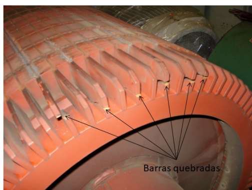
Fig. 1. Rotor tipo gaiola de esquilo com seis barras quebradas de um motor trifásico de indução.
