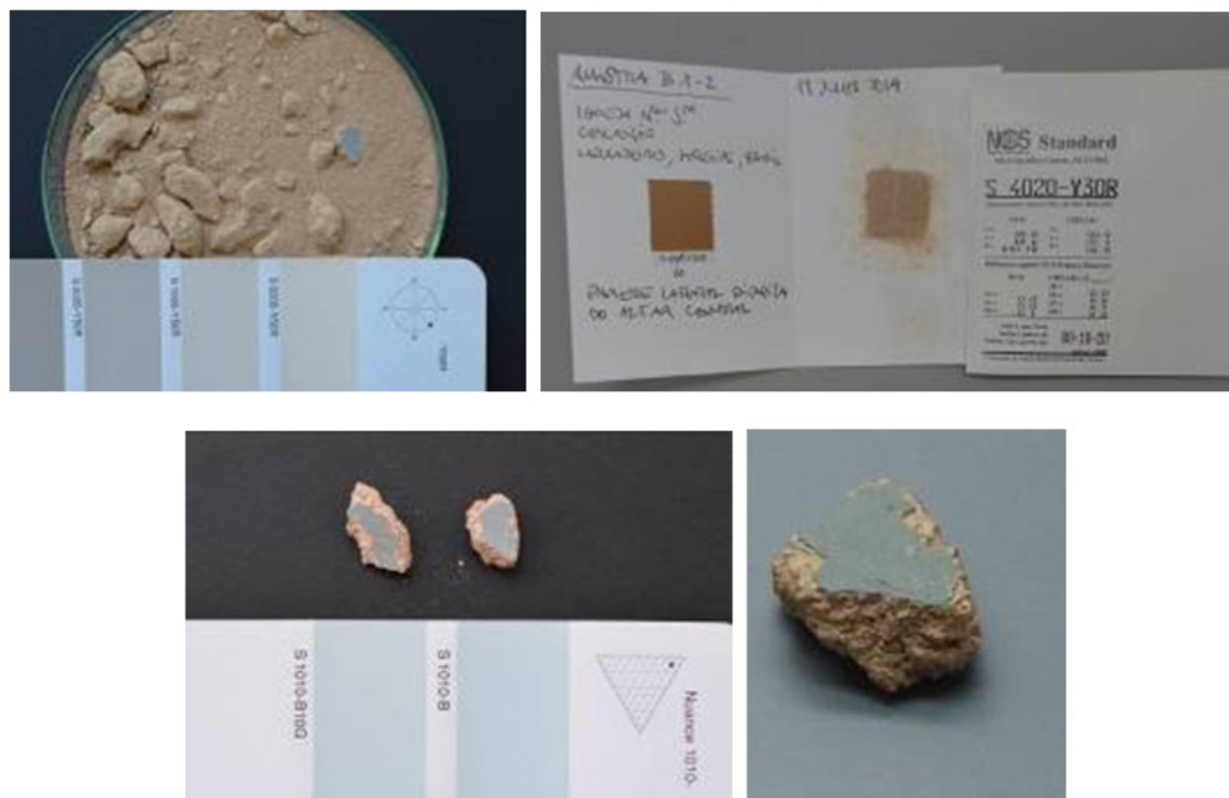
Figura 8 – (acima esquerda): Observação da cor da argamassa no LNEC. (direita acima): Observação da cor da argamassa no MEDCROMA. (abaixo esquerda): Análise dos fragmentos 3 e 4 da amostra B 1-2 no LNEC. (direita abaixo): Detalhe do fragmento 4 analisado no LNEC e no MEDCROMA – pigmento azul. Fonte: Silva, jun. 2014.
