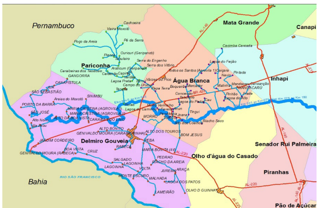
Figura 3 – Plano de adução de água para consumo humano e quintais produtivos das comunidades rurais difusas a partir do Canal do Sertão Alagoano
