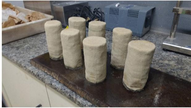
Figura 4. Processo de capeamento dos corpos de prova
