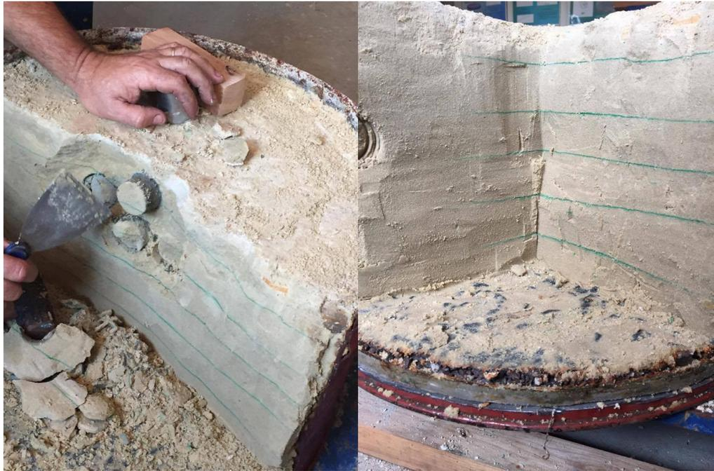
Figura 13. Exumação do CP\_Biocimentado
