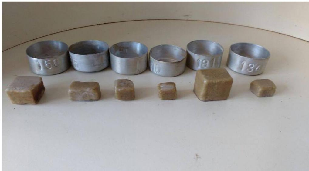
Figura 2. Amostras para verificação da densidade
