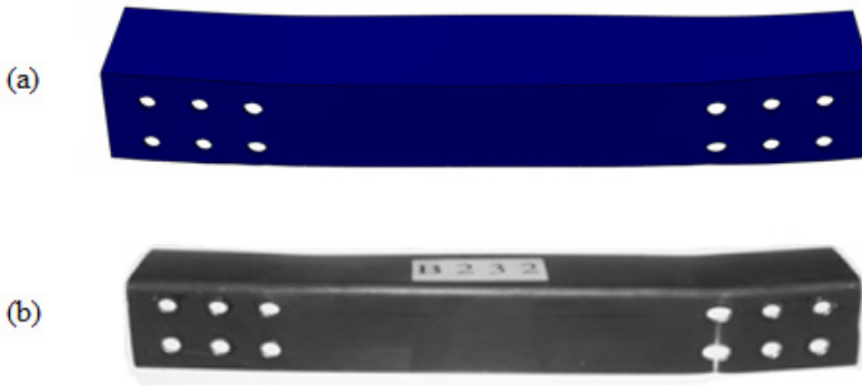
Figura 9 - Deformação numérica (a) e experimental (b) da cantoneira B232 no momento de carga última.
