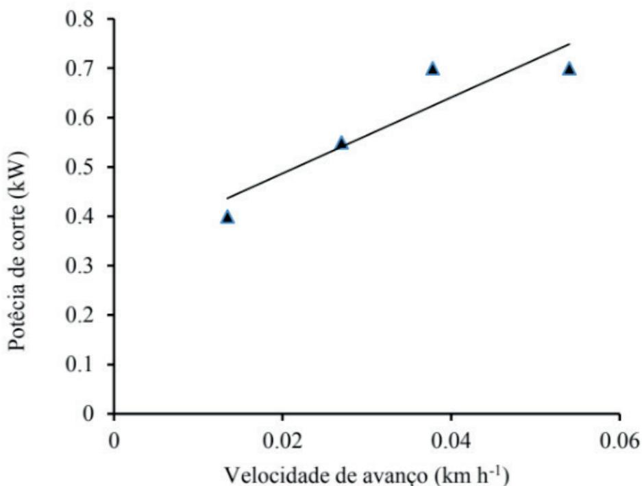
Figura 5. Linha de tendência da potência de corte em função da velocidade de avanço na rotação de 1286rpm
