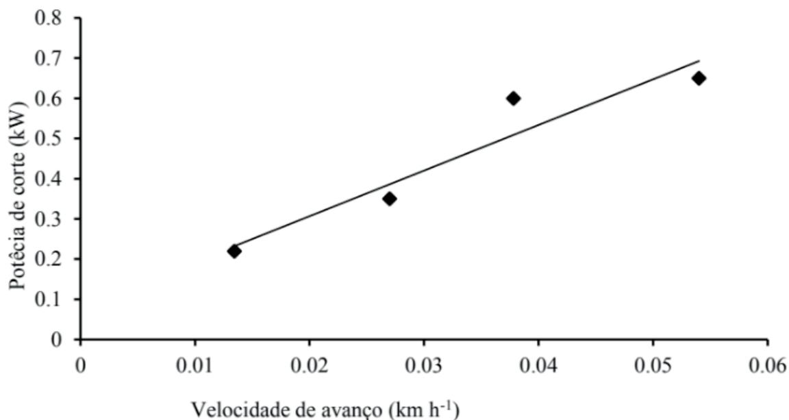
Figura 4. Linha de tendência da potência de corte em função da velocidade de avanço na rotação de 882rpm
