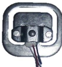
Figura 2. Célula de carga de 50kg (Autoria própria).
