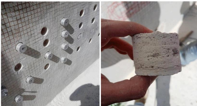
Figura 21 e 22 – Colagens das pastilhas para ensaio e espessura do reboco.
