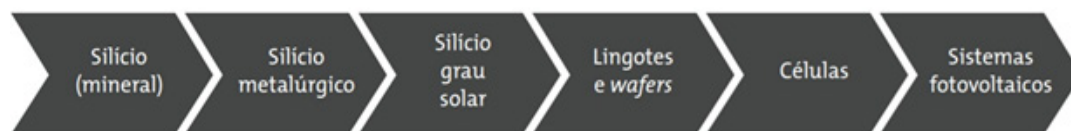
Figura 3 – Cadeia de processamento do silício para sistemas fotovoltaicos.
