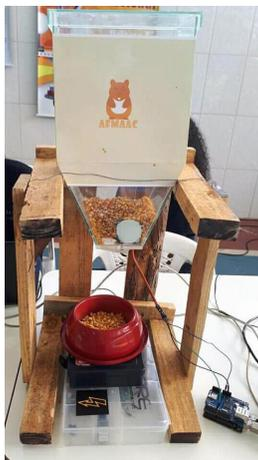
Figura 2.0 – Modelo físico real do dispositivo.
