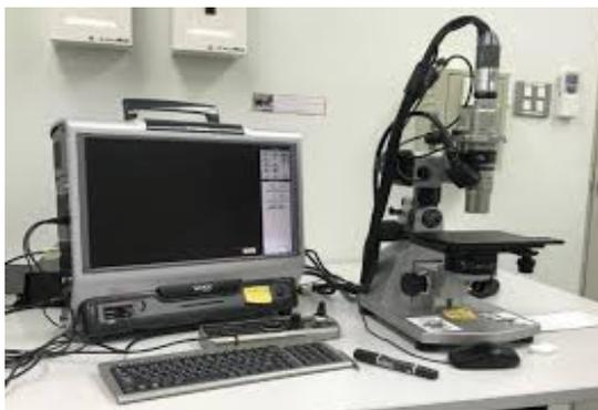
Figura 2. Microscópio digital metalográfico.
