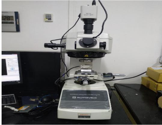
Figura 3. Máquina de medir dureza.
