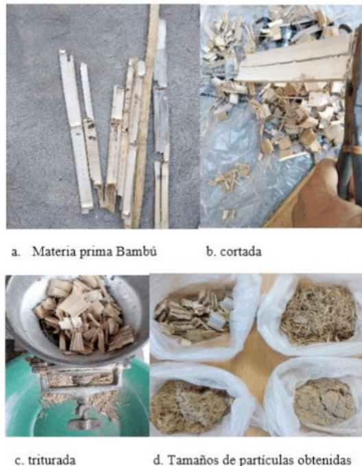
Figura 1. Proceso de obtención de bambú triturado
