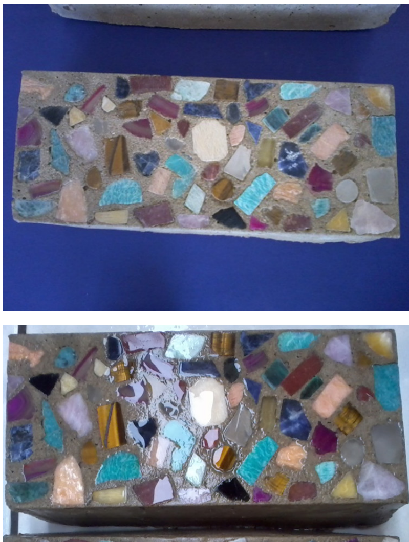
Figura 5: Concreto após o polimento (2ª tentativa) seco e molhado.
