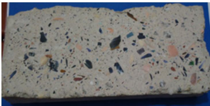
Figura 4: Concreto depois do polimento (1ª tentativa).
