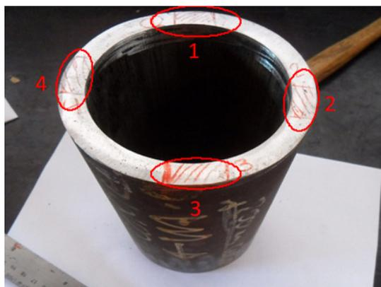
Figura 1. Trecho do tubo onde foram retiradas as amostras.
