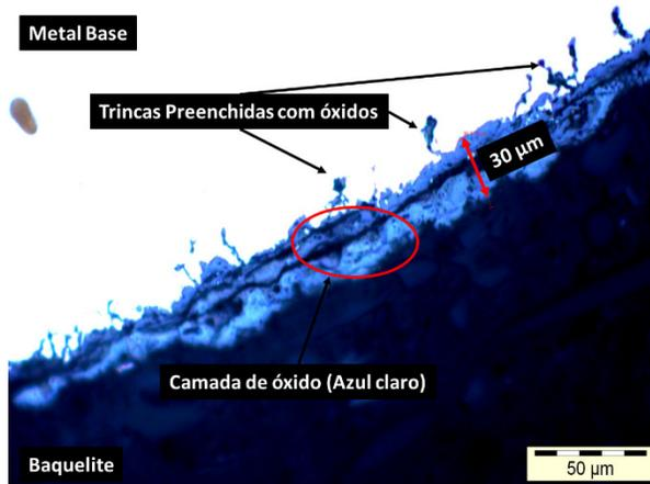
Figura 3. Micrografia da região externa da tubulação.
