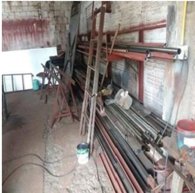
Figura 3 - Armazenamento Inadequado das Vigas Metálicas
