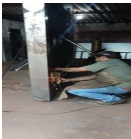
Figura 5 - Processo de Desbaste no Portão
