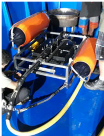
Figura 7 – Boomer modelo Geo-Boomer 300-500, mobilizado na embarcação Sangue Bom e as especificações do equipamento.
