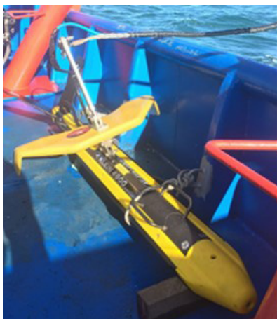
Figura 8 – Sonar de varredura lateral ( side scan sonar ) fabricante Klein, modelo 4900, mobilizado na embarcação Sangue Bom e especificações técnicas do equipamento.
