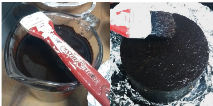
Figura 3 - Aplicação da Emulsão na Interface dos Conjuntos de Amostras.
