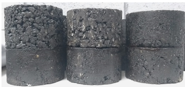
Figura 4 - Conjuntos de Amostras Após a Aplicação da Emulsão em suas Interfaces: Esquerda (BBDr/BBSG), Centro (BBTM/BBSG) e Direita (BBSG/BBSG).
