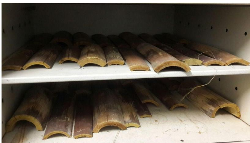
Figura 3 - Bambus colocados na estufa por 24h a 60°C
