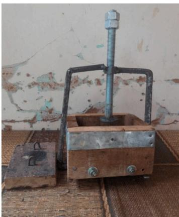
Figura 7 - Prensa utilizada no processo de moldagem do PEAD
