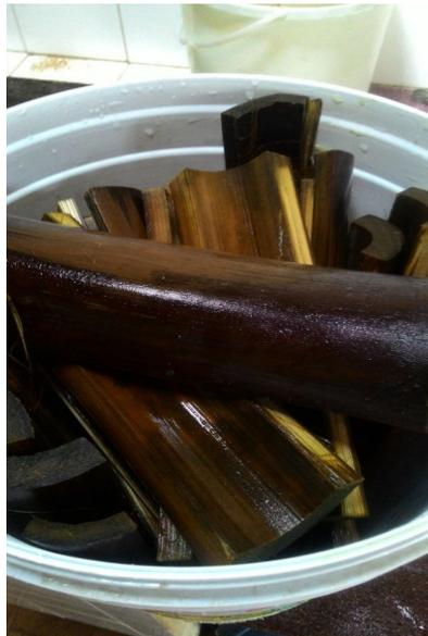
Figura 2 - Bambus cortados imersos em solução de 0,01% de NaOH
