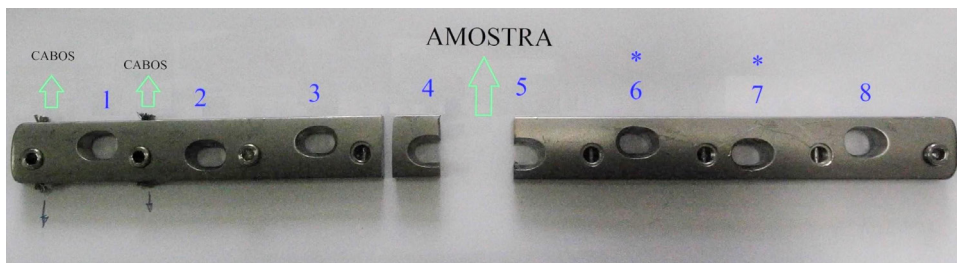
Figura 2 - Placa fraturada com os furos identificados e amostra já cortada para análise da superfície de fratura e outras propriedades. Os furos 6 e 7 apresentaram marcas de deformação internas. Pedacos do cabo usado para a colocação da prótese ainda estavam na placa e estão identificados na imagem.
