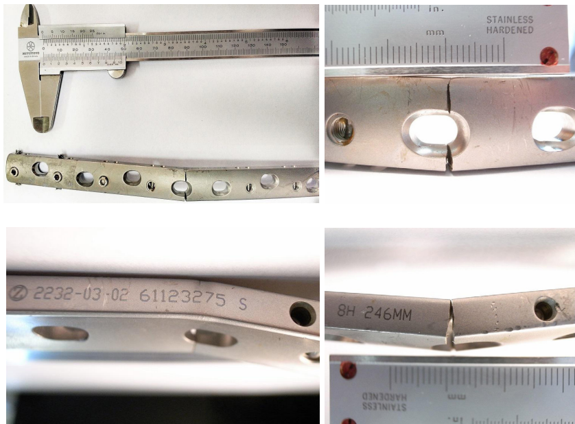
Figura 1 - Placa de osteossíntese fraturada. A falha localizava-se à 117mm à partir do lado esquerdo do início da placa, no quarto furo. Notam-se as inscrições feitas pelo fabricante e que remetem à especificação do tipo de placa.
