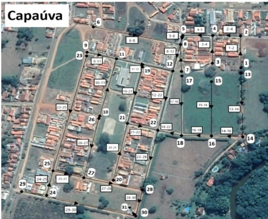
Figura 1 – Interface do SWMM com a rede coletora do Núcleo Capaúva.
