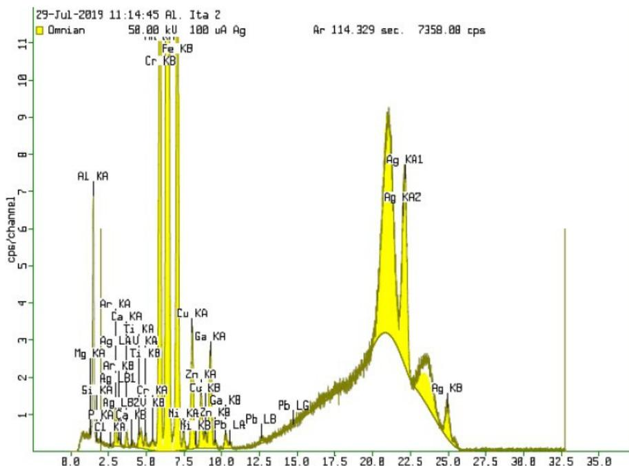
Figura 4 – Espectros obtidos na análise espectrométrica de fluorescência de raios X da amostra européia
