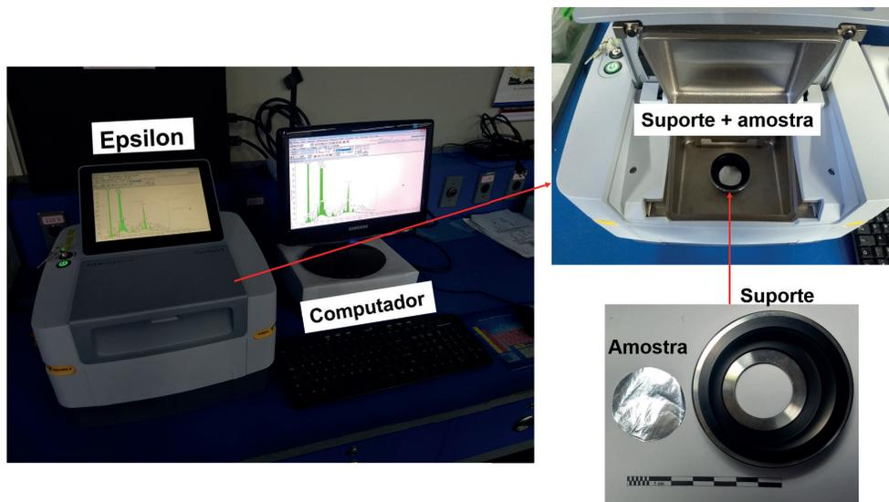
Figura 3 – Detalhe fotográfico do espectrômetro Épsilon 1 da Panalytical
