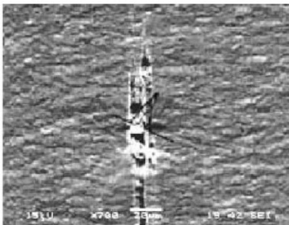
Figura 1 - Rasgo causado por silicatos após laminação
