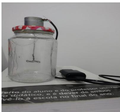
Figura 3: Reator de transesterificação elétrico.
